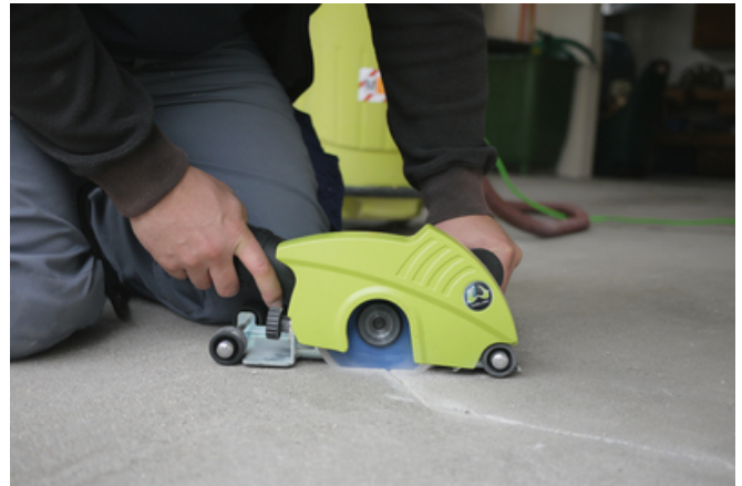
Dekvloerscheuren en voegen verbreden en haakse sleuven slijpen, heel eenvoudig en stofarm met de Wolff EF 135 voegensnijder.
